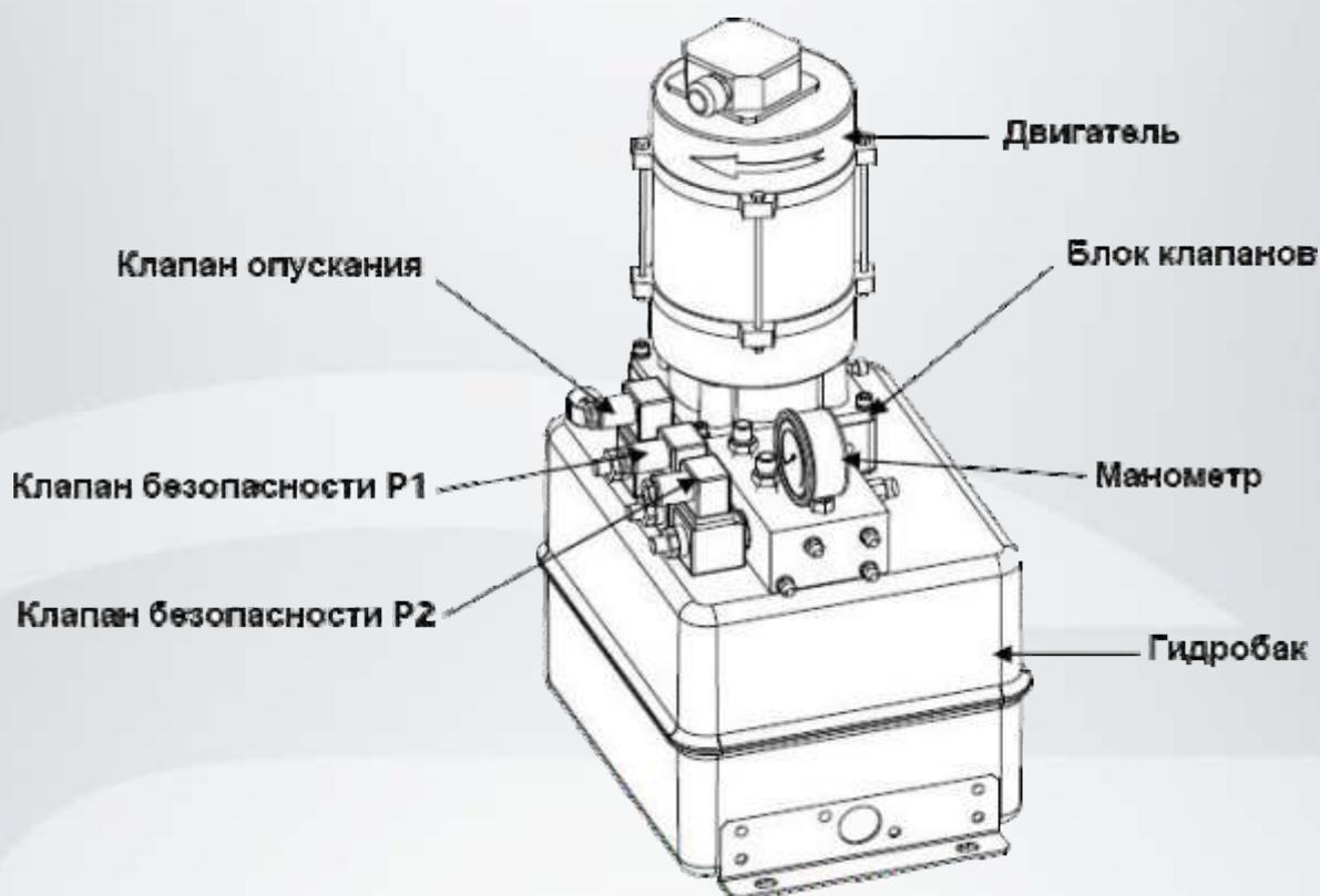
Рисунок 5.2 - Гидростанция
