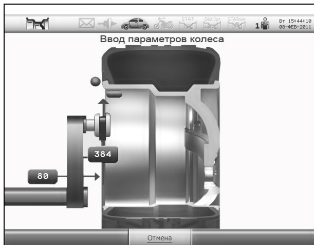
Рисунок 5.3 – Экран при первом измерении
