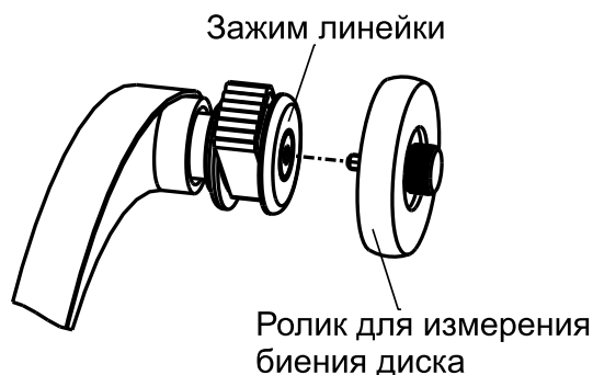
Рисунок 7.5 – Ролик для измерения биений
