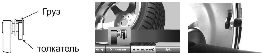
Рисунок 5.13 – Установка груза линейкой
