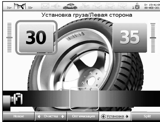
Рисунок 5.12 – Экран при установке груза линейкой
