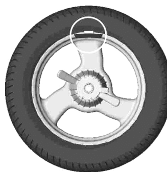
б - груз установлен в положение «12 часов»
