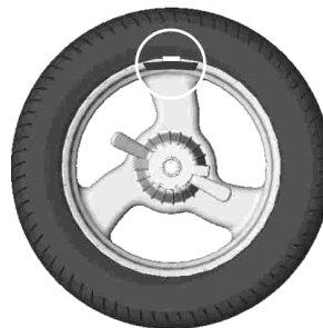
Рисунок 6.6 - Груз установлен в «12 часов»
